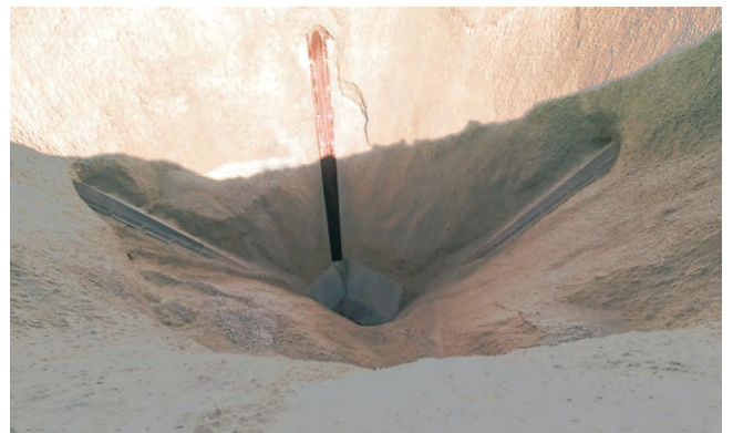
Isobare Schwertdüsen beseitigen und vermeiden Austragsstörungen. Die Haldenkapazität wird erhöht.
