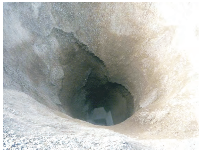
Ohne Schwertdüsen: Trichter- und Brückenbildung, geringes aktives Haldenvolumen.
